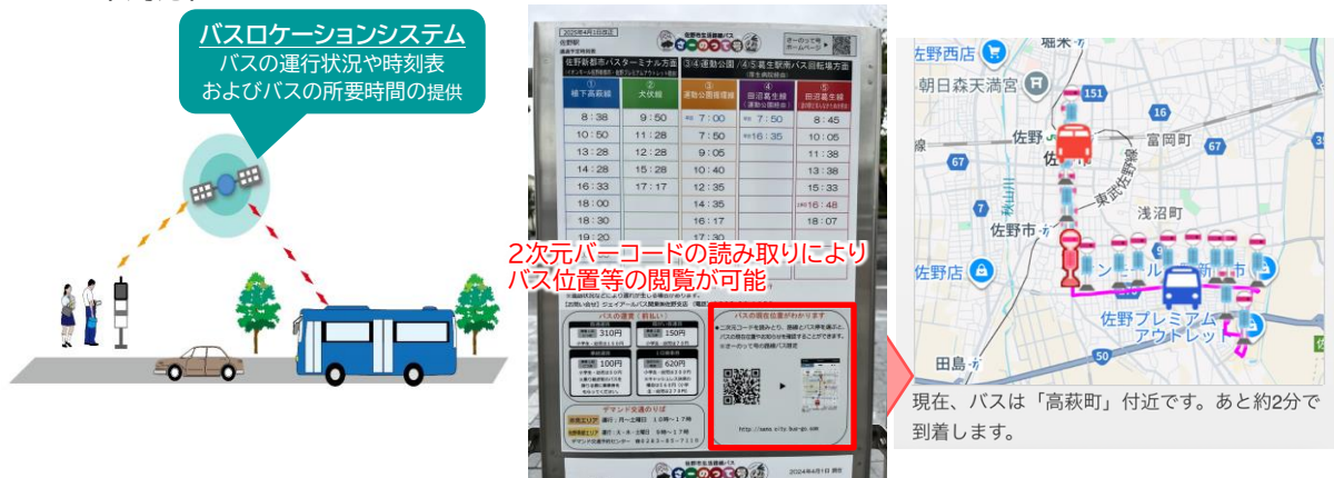
図 2-6 バスロケーションシステムの概要図
