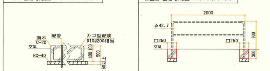
X-X' 基礎 詳細図 SC 1/30 (A1), 1/60 (A3)
