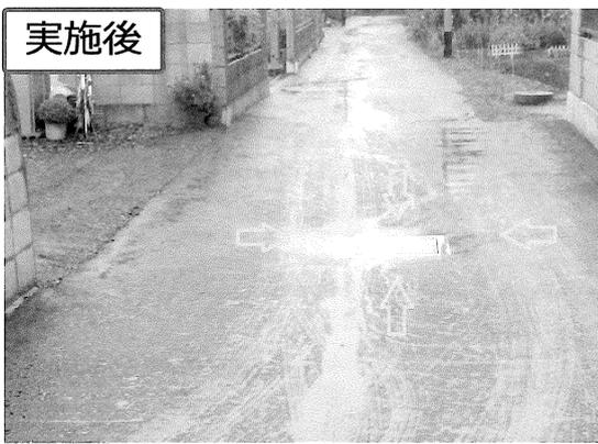
②県道 唐沢山公園線は、交差点付近の道幅が狭い上、速度を落とさず交差点に進入する車があり、以前から通学路としての安全性が指摘されてきました。今回、拡幅計画の実施までの暫定処置として、①停止線を後退 ②手前から車道を狭める ③路側帯のカラー舗装 を実施して頂きました。
