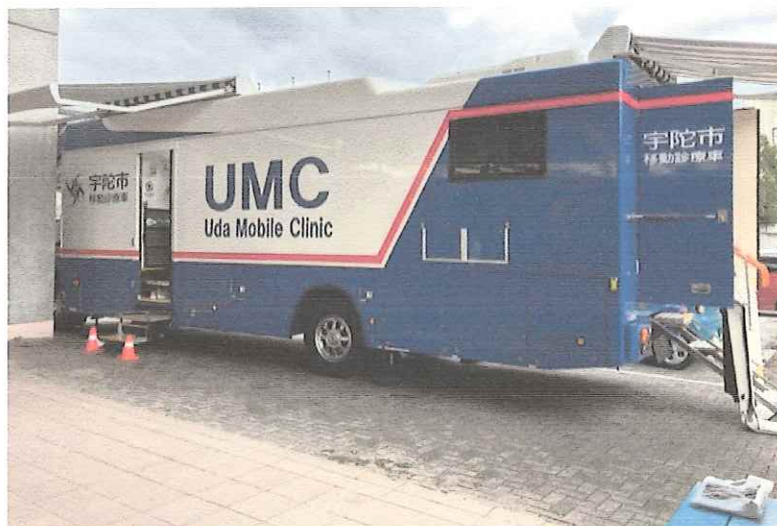
移動診療車。医療機器は通常は蓄電池で稼働。エンジンでも稼働でき災害時にも活用可能。
