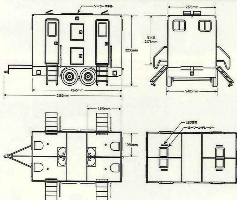
標準仕様 ■車両重量: 2500kg ■清水タンク: 454L(水洗・手洗い用) ■汚水タンク: 757L
