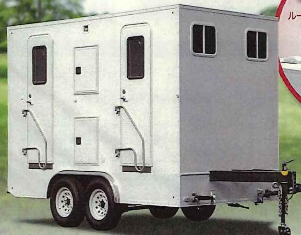
大きさは、車体幅が2420mm、Aフレームまで入れた全長が5585mmと、中型トラックほどのサイズですので、平常時には、アウトドアイベントや土木・建設現場などの仮設トイレとしても活用できます。
